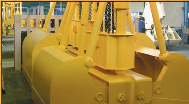
Cucharas mecánicas automáticas accionadas mediante una sola cadena o cable.
