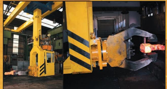
Pinza para forja sobre manipulador telescópico. Integrada en la misma grúa.
